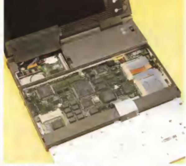
La macchina con la tastiera estesa | a destra il Pannello di comando. Notare in alto e sinistra il vano per il reader opzionale
